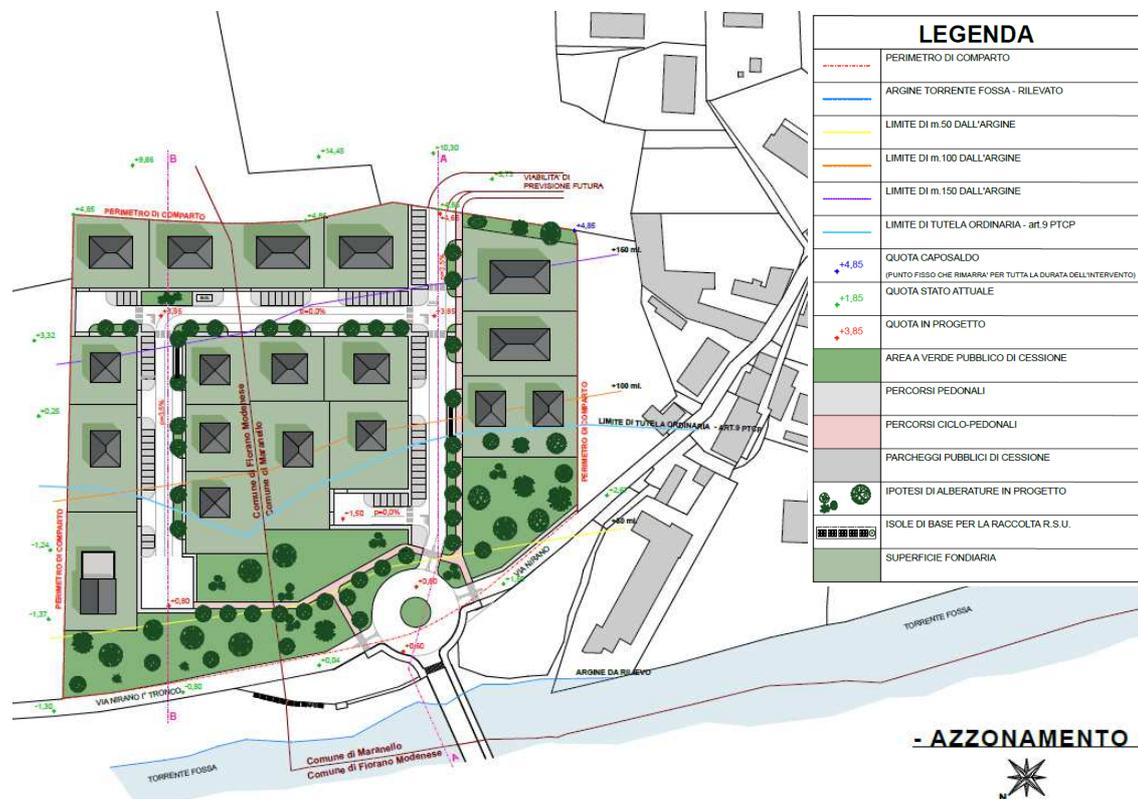
Figura 4 – Stato di progetto del comparto “PIEMME – Torre Oche” – trasformazione da stabilimento ceramico a quartiere residenziale.
