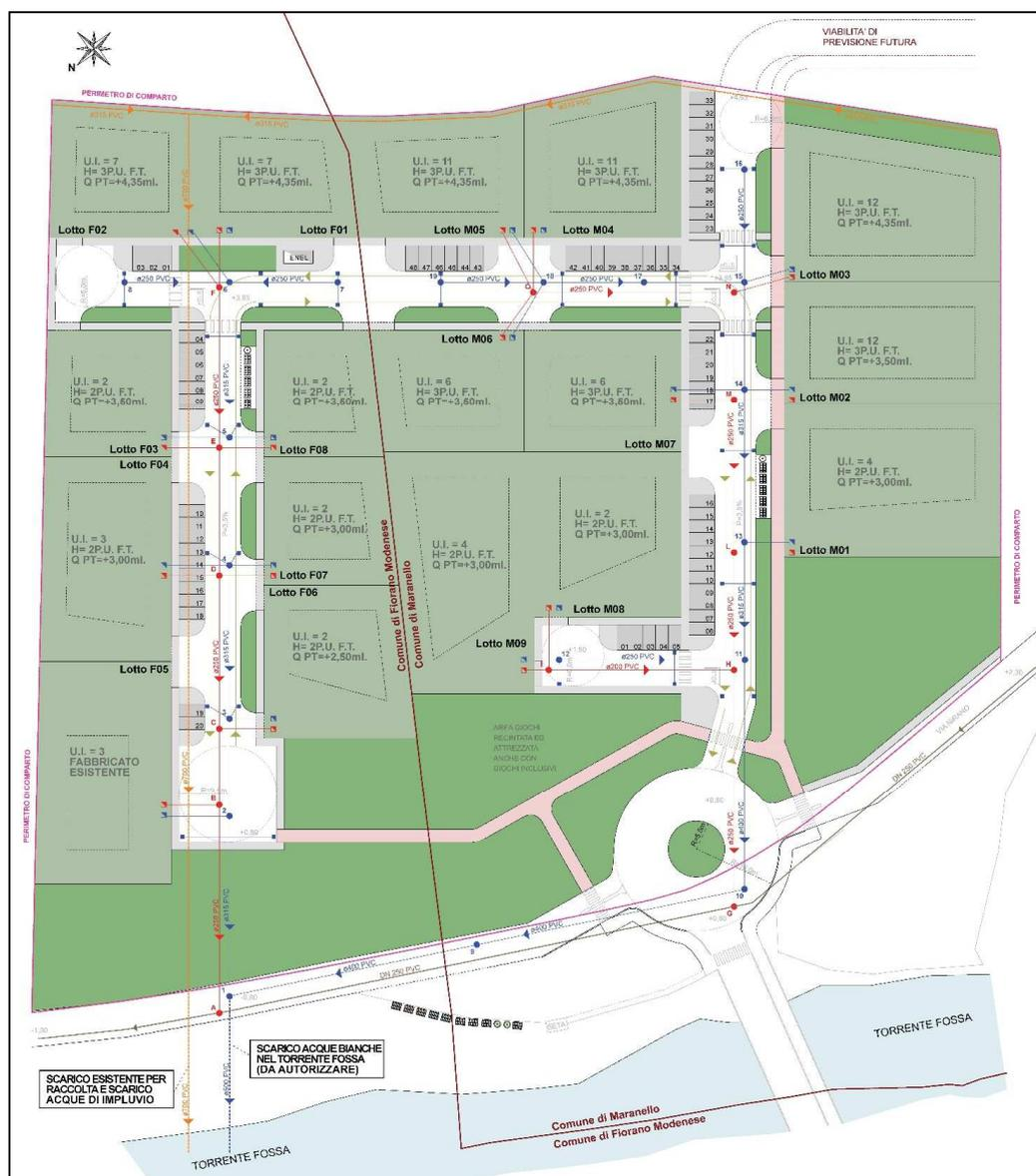
Figura 63 - Planimetria di progetto del comparto, con illustrati gli schemi delle reti di scolo delle acque bianche in blu, delle acque reflue in rosso e del fosso che attraversa il comparto in arancione.
