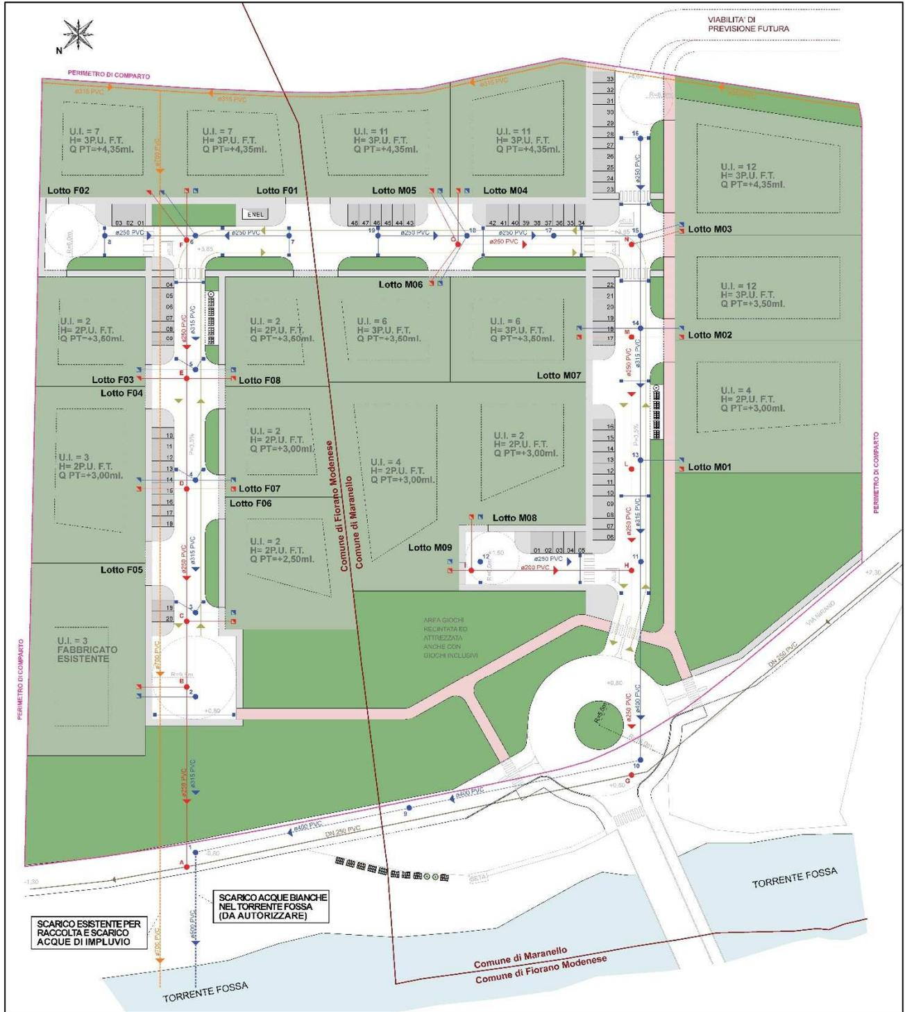
Figura 14 – Planimetria di progetto del comparto, con illustrati gli schemi delle reti di scolo delle acque bianche in blu, delle acque reflue in rosso e del fosso che attraversa il comparto in arancione (Tavola n. 8 “Hera fognatura”).
