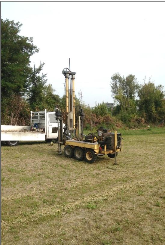
Foto 3: Realizzazione del sondaggio penetrometrico **Din4**.
