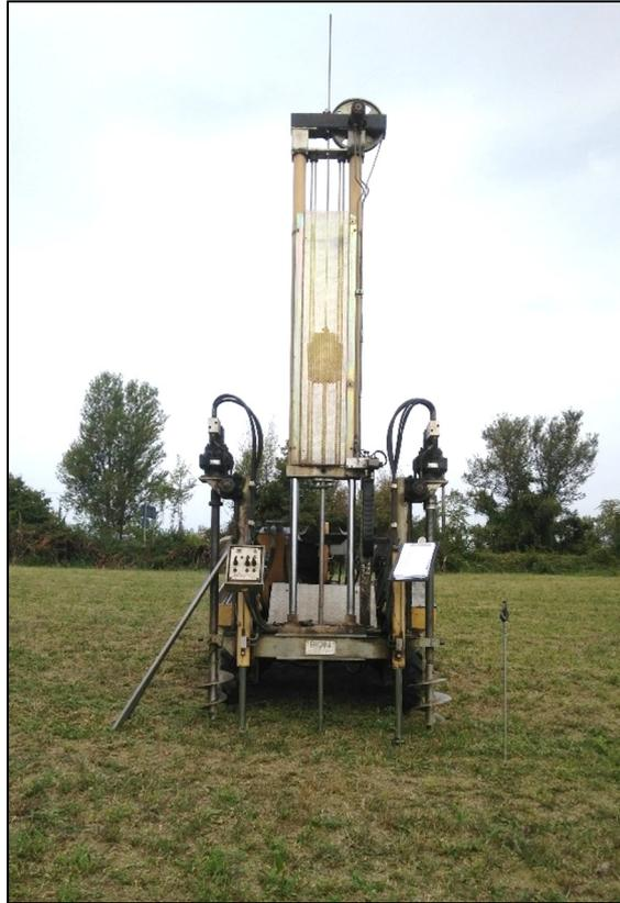
Foto 2: Realizzazione del sondaggio penetrometrico **Din2**.
