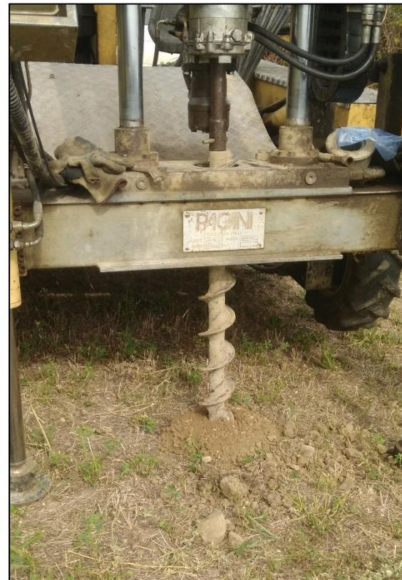
Foto 4: Realizzazione del carotaggio per la raccolta dei campioni di terra da analizzare.
