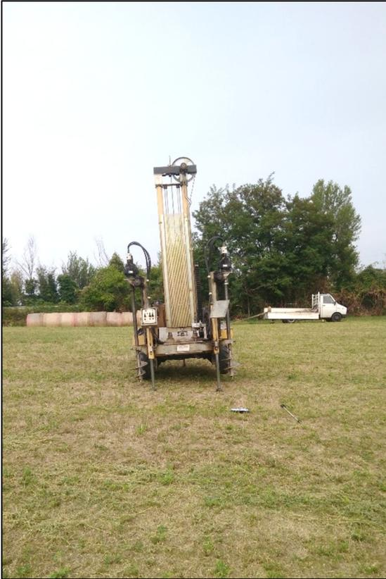
Foto 1: Realizzazione del sondaggio penetrometrico **Din1**.
