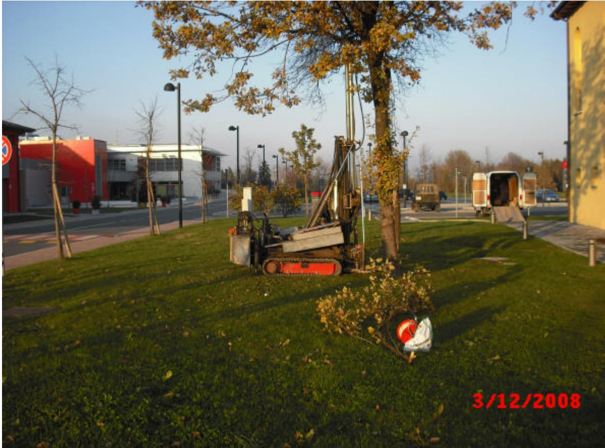
**Foto. n. 3.2 – Esecuzione prova penetrometrica statica CPT n.1 realizzata in corrispondenza dell'area che sarà occupata dal nuovo ampliamento.**
