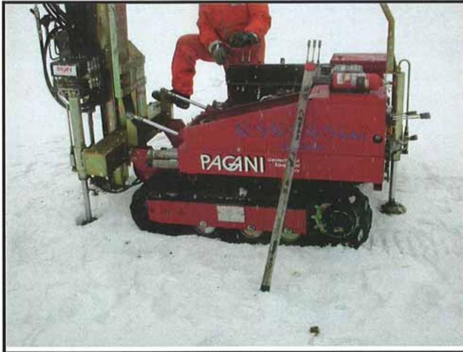
FOTO 3, PIAZZAMENTO CAROTAGGIO “GEOPROBE” p7 E FUSTELLA DI CAMPIONAMENTO DA 0,0 A 1,2 M DAL P.C. ▲
