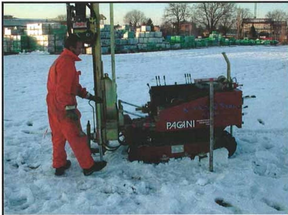
FOTO 4, PIAZZAMENTO CAROTAGGIO “GEOPROBE” p16 E FUSTELLA DI CAMPIONAMENTO DA 0,0 A 1,2 M DAL P.C. ▲
