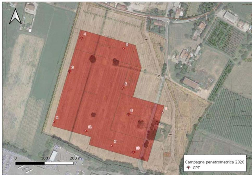
Figura 18 – Ubicazione dei 10 sondaggi penetrometrici statici eseguiti per questo studio. Il poligono con campitura rossa rappresenta l'impronta del futuro stabilimento produttivo.
