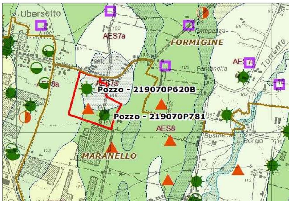
Figura 9 – Sondaggi geognostici della banca dati regionale presenti all'interno ed in prossimità dell'area d'indagine, identificata col poligono rosso.
